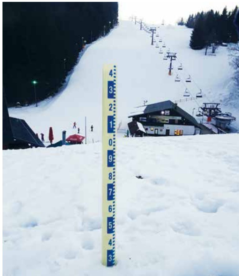
Obr. 11. Měření vodní hodnoty sněhu pomocí sněhoměru ve Vítkovicích Fig. 11. Measurement of water value of snow using snow meter in Vítkovice
