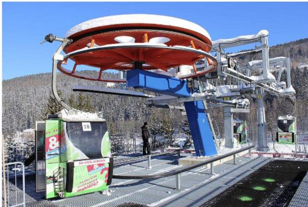
Velký unikát se v roce 2015 rozjel v Herlíkovicích – jde o přibližovací neodpojitelnou čtyřmístnou kabinkovou lanovku, jejíž kabinky a podpěry pocházejí ze Skalnatého Plesa
